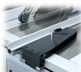
**Электромеханический продольный упор.** Перемещаемый со скоростью 250 мм/сек. посредством электродвигателя продольный упор останавливается в заданном положении с точностью  $\pm 0,1$  мм. П
