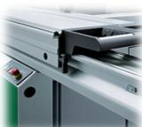
**Двухроликовая каретка.** Легкость хода системы достигается за счет роликов большого размера. Каретка приводится в движение с минимальным усилием и перемещается легко как по рельсам. Такое качество хода сохраняется даже после многолетнего использования станка в обычных условиях.
