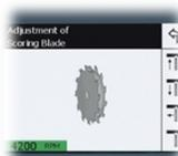
**Электромеханическая настройка 2-координатного подрезателя.** Пильный диск переводится в нужную позицию в считанные секунды – для этого достаточно выбрать из экранного меню соответствующие команды и значения. Значение глубины при следующем включении подрезатель устанавливается на эту высоту.
